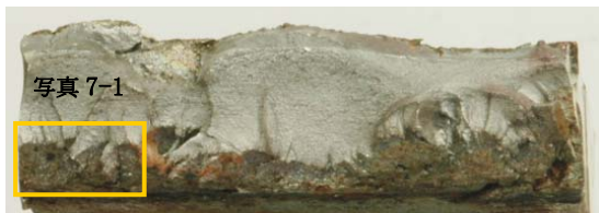
写真 6 破断後の試験片（試料Ⅲ：荷重非伝達型）
