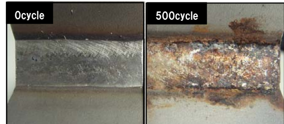
写真1 腐食前(0cycle)と腐食後(500cycle)の比較
